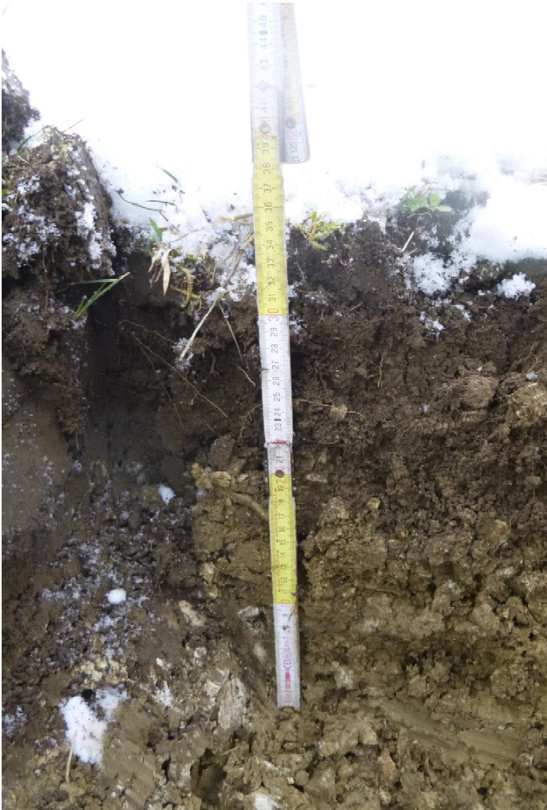
Foto 3: Baggerschurf 2 im Bereich der neuen Straßentrasse, Detailaufnahme zeigt den ca. 15-20cm mächtigen Oberboden
