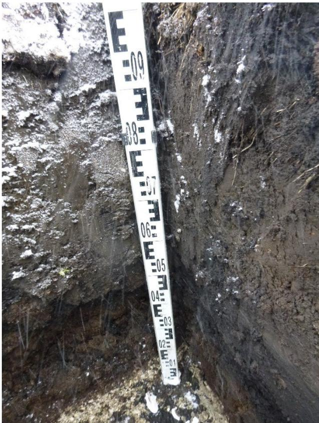
Foto 14: Baggerschurf 8 Deteilaufnahme zeigt den Übergangsbereich kulturfähiger Oberboden zum anstehenden Hangschutt.
