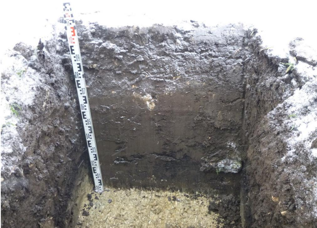
Foto 10: Baggerschurf 6, Detailaufnahme zeigt den ca. 80cm mächtigen Oberboden und die darunter anstehende Hangschuttablagerungen
