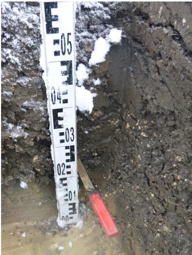
Foto 5: Baggerschurf 3 Detailaufnahme zeigt den Übergangsbereich kulturfähiger Oberboden zum anstehenden Hangschutt.
