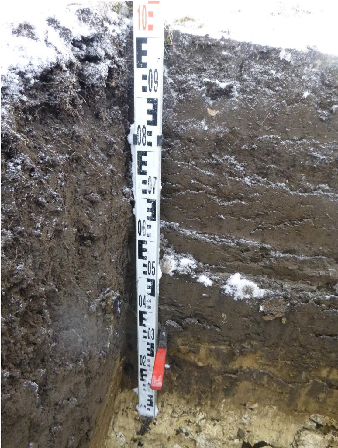
Foto 6: Baggerstich 4 im Bereich der neuen Kleingewerbegebietes, Detailaufnahme zeigt den Übergangsbereich Oberboden/ anstehender Hangschutt
