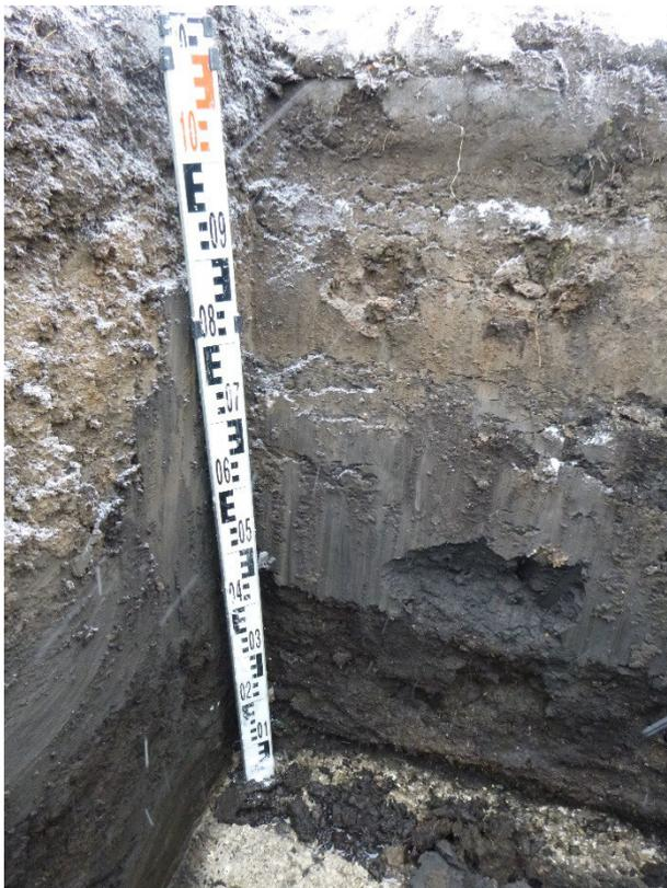
Foto 12: Baggerschurf 7 Detailaufnahme zeigt den Übergangsbereich kulturfähiger Oberboden zum anstehenden Hangschutt.
