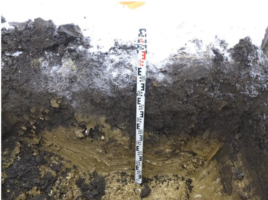
Foto 8: Baggerschurf 5, Detailaufnahme zeigt den ca. 50cm mächtigen Oberboden
