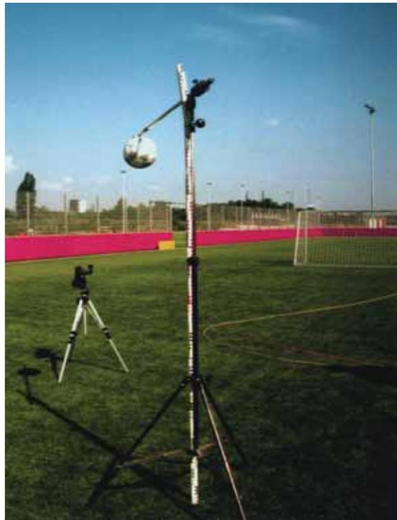
Abb. 6: Messgerät vertikales Ballsprungverhalten
