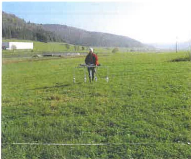
Abb. 1: Vier Spur - Cäsiummagnetometer G858 (Totalfeldmessung) mit speziell entwickeltem Tragegestell.
